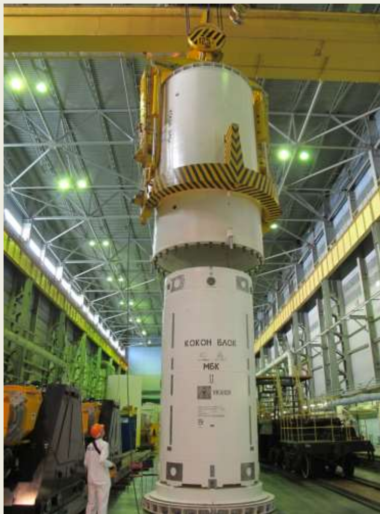
Снятие защитно-демпфирующего кожуха с УХ-109
