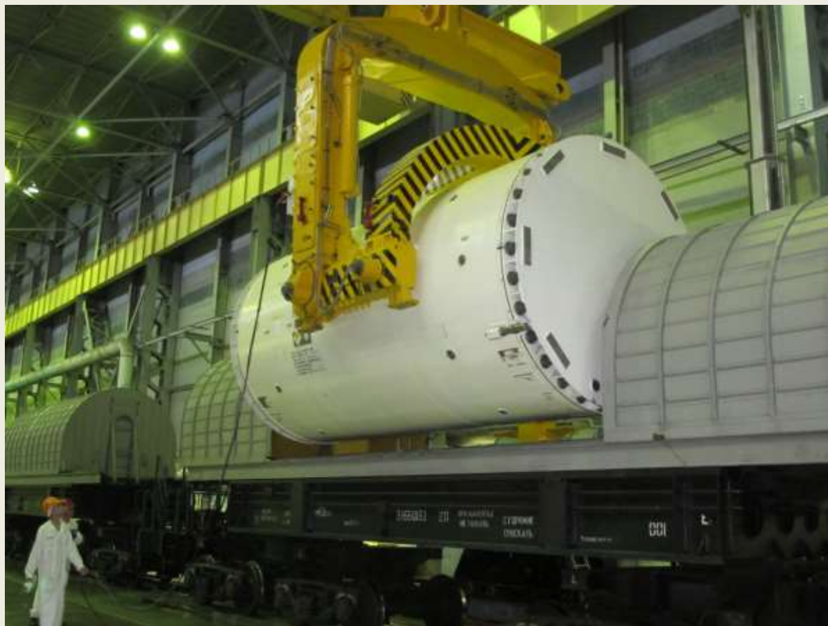
Прием транспорта с ОЯТ в здании 855, снятие ТУК-109 с транспортера
