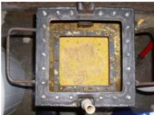
Установка пропитки ИОС в контейнере
