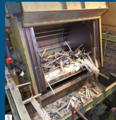
5 ONTLADEN VAN DE STRAALTROMMEL DISCHARGE OF THE BLASTING CHAMBER
