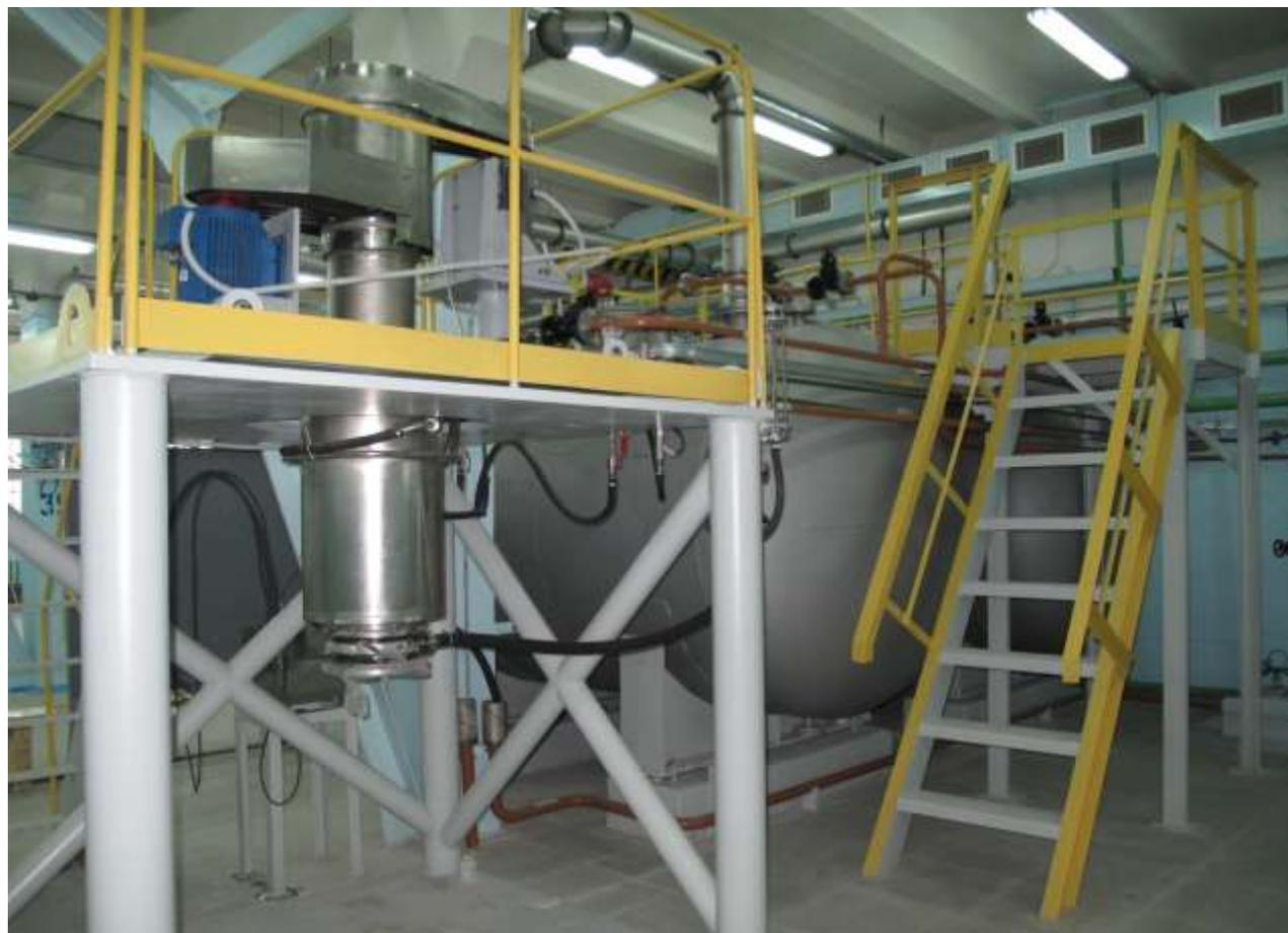
Узел разделения пульпы смонтирован в 2012 году. Принят в промышленную эксплуатацию в 2015 году. В состав узла входит вертикальная центрифуга «Н-350» изготовленная ОАО «СвердНИИхиммаш». Максимальная производительность центрифуги по пульпе – 4 м<sup>3</sup>/ч. Максимальная производительность по осадку – 400 кг/ч. Ориентировочная стоимость узла разделения – 27000 тыс.руб, из них центрифуга – 8000 тыс.руб (данные по ценам на 2009-2011 год).
