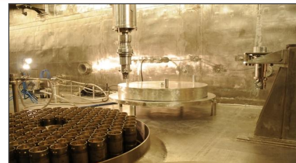
Перегрузка ОЯТ на ФГУП «ГХК» в «сухое» хранилище
