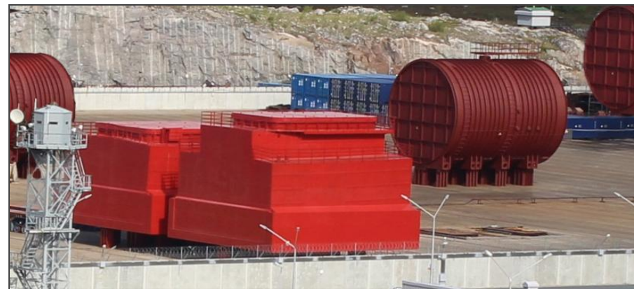
Блок-упаковки плавтехбазы «Володарский» внутри каждой до 800 т РАО
