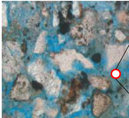
Оптическая микроскопия Максимальный размер пор до 50 мкм
