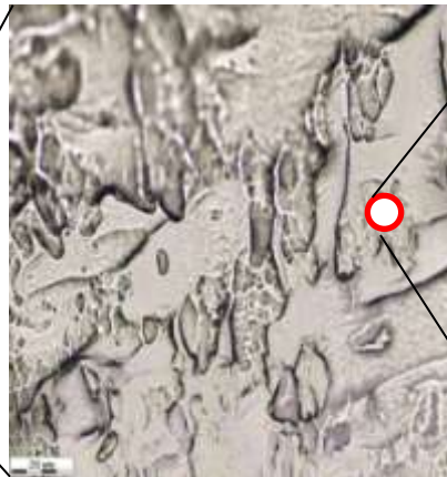
Оптическая микроскопия Полимер заполнил поровое пространство
